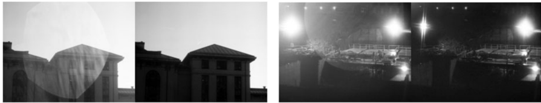
図 1 実験結果 左が除去前, 右が除去後. 水滴が原因で発生しているグレアが除去できている Our technique detects and removes glare caused by water.
