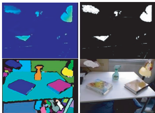
図3 Motion segmentation の流れ (左上：誤差画像, 右上：2 値化された誤差画像, 左下：幾何学的 segmentation 結果, 右下：移動物体のマスク結果)
