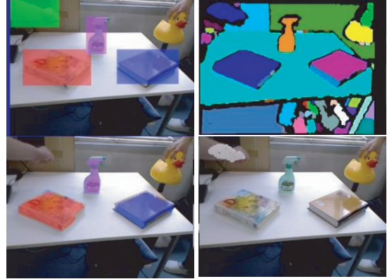
図2 Instance segmentation の流れ (左上: Object detection, 右上: 幾何学的 segmentation, 左下: instance segmentation 結果, 右下: 非剛体物体マスク結果)
