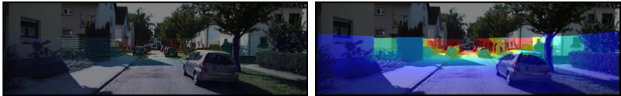
(a) LIDAR による 3 次元点群を入力画像に投影した結果 (b) (a) にバイラテラルフィルタリングして生成した距離画像
